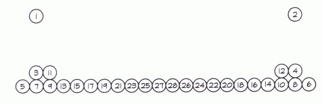
DETENSIONING SCHEDULE N.T.S.
