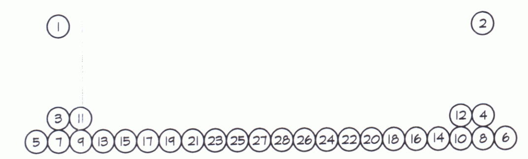
DETENSIONING SCHEDULE N.T.S.
