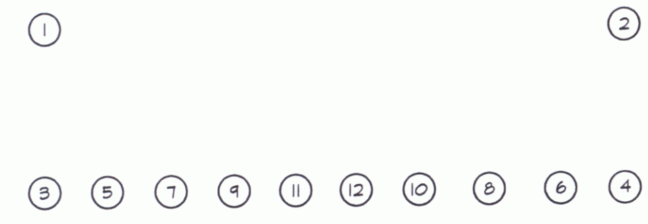
DETENSIONING SCHEDULE N.T.S.
