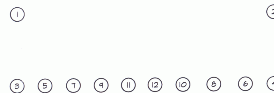
DETENSIONING SCHEDULE N.T.S.
