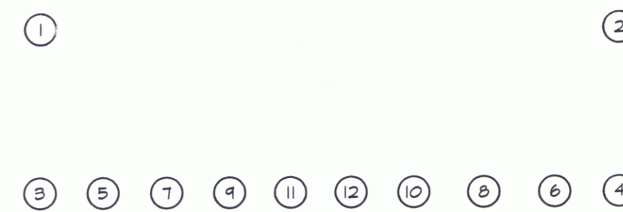
DETENSIONING SCHEDULE N.T.S.
